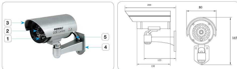
1. Capteur de luminosité pour allumer ou non les led infra-rouge.
