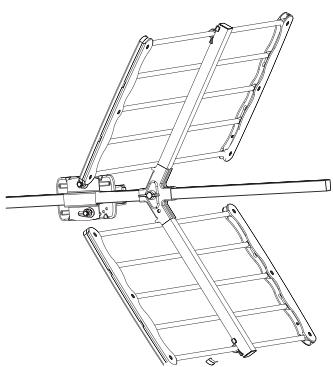
Dépliez les 2 grilles comme sur le schéma ci-dessus. Placez une 1ère grille sur la bras de l'antenne puis la 2ème comme sur le schéma ci-dessus.
