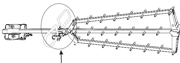
Dévissez l'écrou situé sur le dipôle, puis passez la vis dans le trou du bras central puis vissez l'écrou pour fixer l'ensemble.
