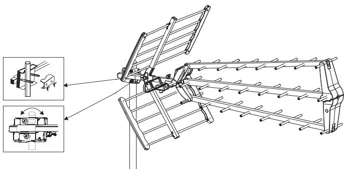
Coloque la brida de fijación sobre el brazo central de la antena.
