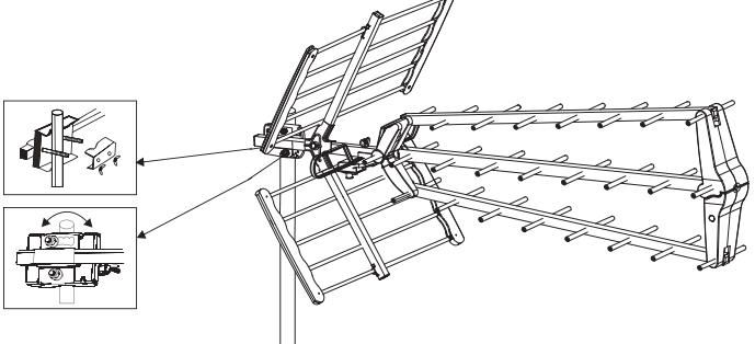
Placez la bride de fixation sur le bras central de l'antenne.
