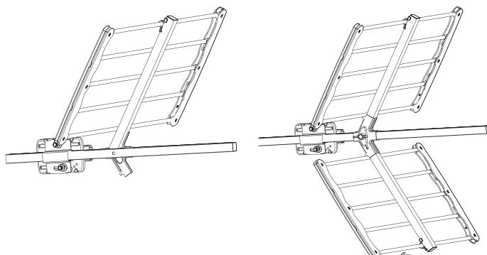
Despliegue las 2 rejillas como en el diagrama de arriba. Coloque una primera cuadrícula en el brazo de la antena y luego la segunda como se muestra en el diagrama anterior. Para completar la fijación, será necesario insertar y atornillar el tornillo con la tuerca de mariposa que cruzará los 2 soportes de las rejillas y el brazo de la antena.
