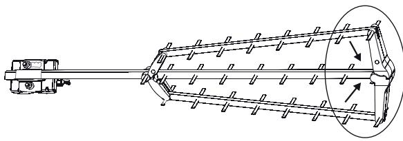
Despregadura os 2 braços de modo que obtenha a forma como sobre a fotografia aqui em parte superior.
