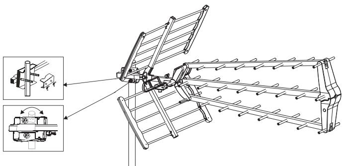
Coloquem o freio de fixação sobre o braço central da antena. Insiram seguidamente a maxila com as nozes borboleta e aperta o conjunto.
