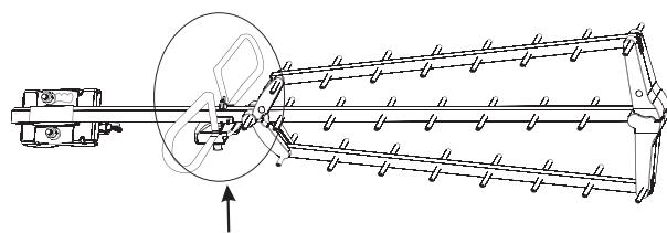
Desatornille la tuerca situada sobre el dipolo, luego pase el tornillo en el agujero del brazo central luego atornille la tuerca para fijar el conjunto.
