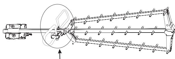
Desaparafusou a noz situada sobre o bipolo, por conseguinte passa o parafuso no buraco do braço central seguidamente aparafusa a noz para fixar o conjunto.
