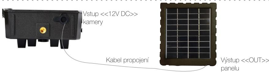
1. Použijte napájecí kabel a zasuňte ho do konektoru OUT na solárním panelu.
