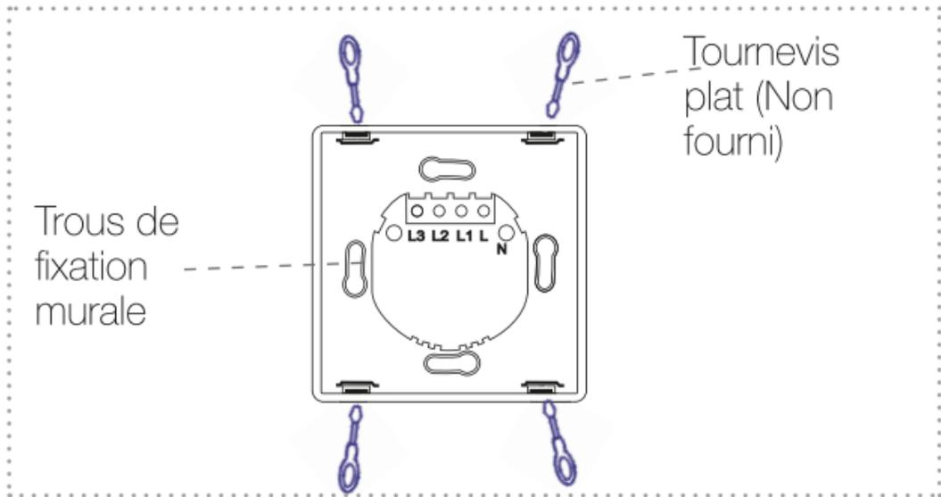
Une fois ouvert, placez l'interrupteur sur les vis de votre boîte d'encastrement puis serrez-les. Remplacez ensuite la face avant et appuyez afin d'entendre les clips.
