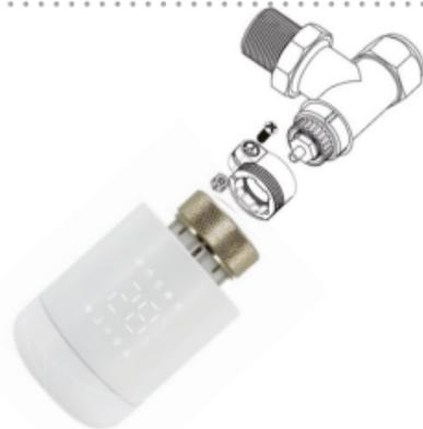
Schéma de montage valve B
