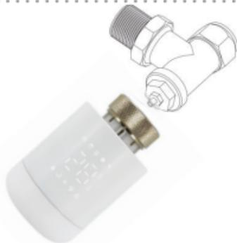
Avant de monter le robinet sur votre radiateur, insérez les 3 piles comme indiqué à l'étape précédente. Vous pourrez alors sentir une vibration sur le robinet qui indique que le robinet entre en mode de détection automatique. La mention «**LA**» s'affichera sur l'écran. Alignez ensuite l'écrou du robinet thermostatique sur la valve du radiateur. Poussez légèrement puis vissez l'écrou dans le sens des aiguilles d'une montre. La température ambiante sera alors affichée et le
