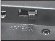
Pour utiliser le piège en mode live (Détection de mouvement, enregistrement...), placez le curseur de sélection sur le mode «**ON**».
