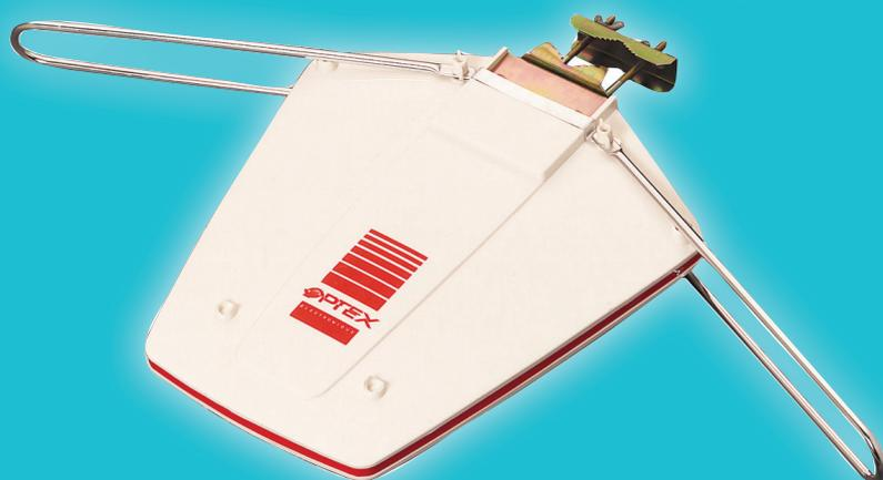
Cette antenne spécial camping vous permet la réception des signaux analogiques et numériques terrestre TNT en simple ou haute définition. Son alimentation est intégrée et s'effectue directement sur le 230V~ au moyen du transformateur fournit. Elle également être alimentée au travers du câble coaxial avec la fonction 5Volts du téléviseur ou décodeur TNT.
