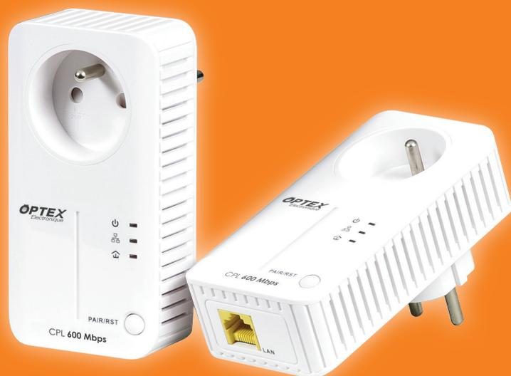
Ces adaptateurs CPL 600Mb/s (Courant porteur en ligne) vous permettront de vous connecter de n'importe quelle prise électrique de votre habitation, partagez vos informations et surfez sur internet! Ils permettent de récupérer le signal réseau avec la connexion RJ45 au de vos prises électriques de votre réseau électrique existant.
