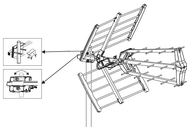
Coloquem o freio de fixação sobre o braço central da antena. Insiram seguidamente a maxila com as nozes borboleta e aperta o conjunto.
