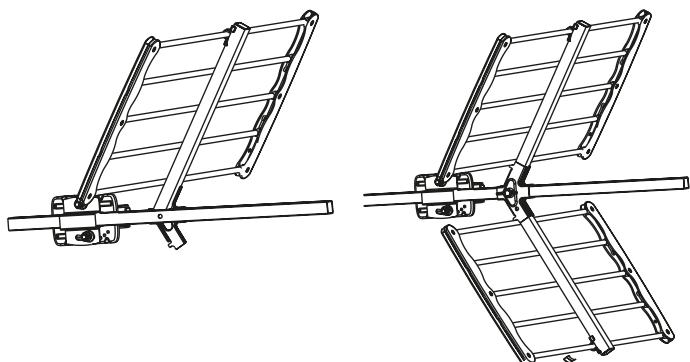
Dépliez les 2 grilles comme sur le schéma ci-dessus. Placez une 1ère grille sur la bras de l'antenne puis la 2ème comme sur le schéma ci-dessus.
