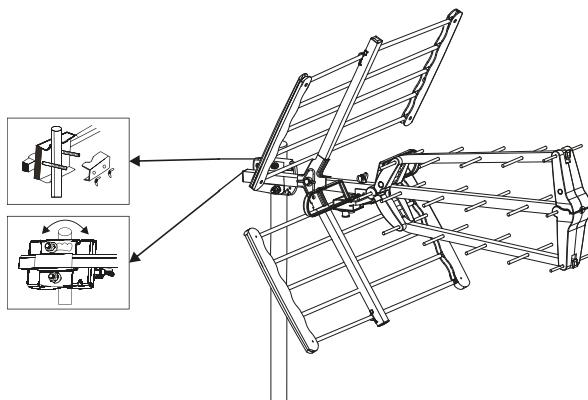
Placez la bride de fixation sur le bras central de l'antenne.
