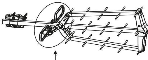
Dévissez l'écrou situé sur le dipôle, puis passez la vis dans le trou du bras central puis vissez l'écrou pour fixer l'ensemble.
