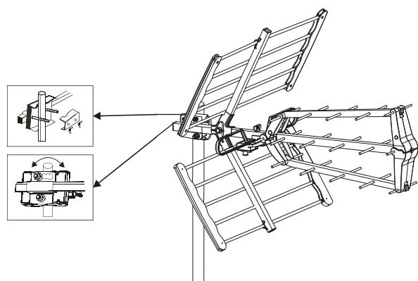
Coloque la brida de fijación sobre el brazo central de la antena.
