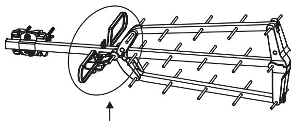
Desaparafusou a noz situada sobre o bipolo, por conseguinte passa o parafuso no buraco do braço central seguidamente aparafusa a noz para fixar o conjunto.
