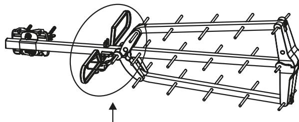
Desatornille la tuerca situada sobre el dipolo, luego pase el tornillo en el agujero del brazo central luego atornille la tuerca para fijar el conjunto.
