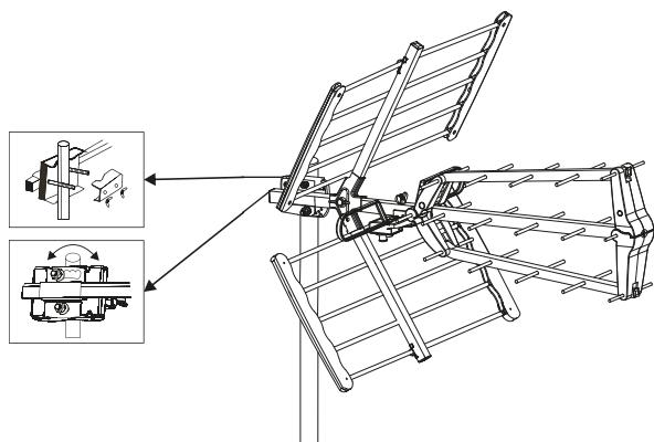
Umístěte svorku na centrální rameno antény. Vložte čelisti s křídlovými maticemi a utáhněte
