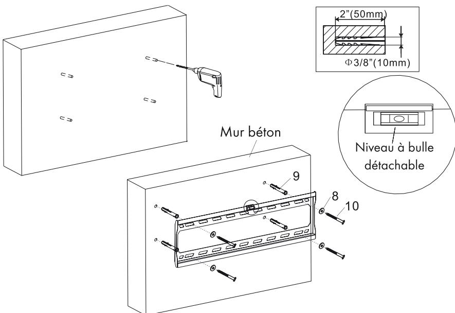
3. Lorsque les trous sont pointés, utilisez une mèche (spéciale béton) de diamètre 10mm pour percer les trous sur une longueur de 50 mm.
