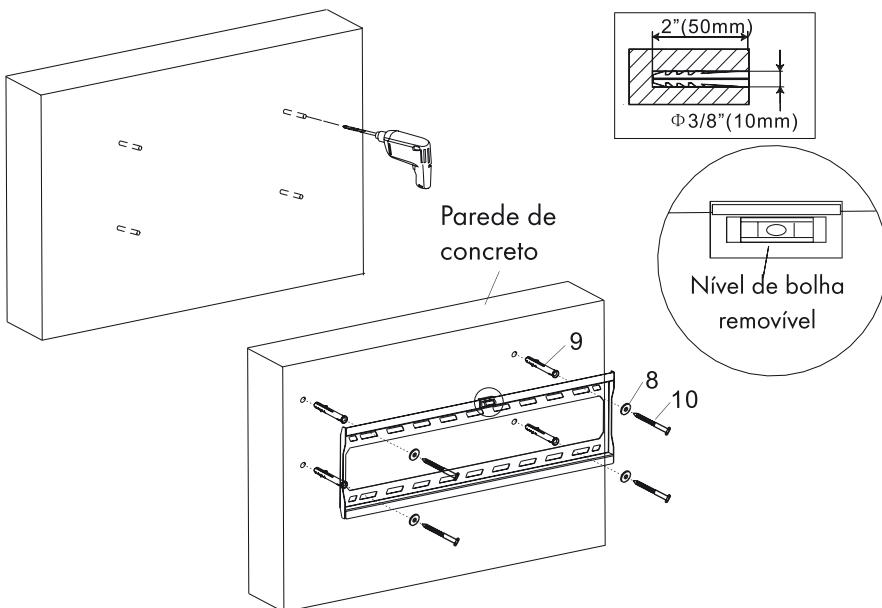
3. Quando os furos são marcados, use um pouco de (concreto especial) de diâmetro de 10mm para fazer furos em um comprimento de 50 mm.
