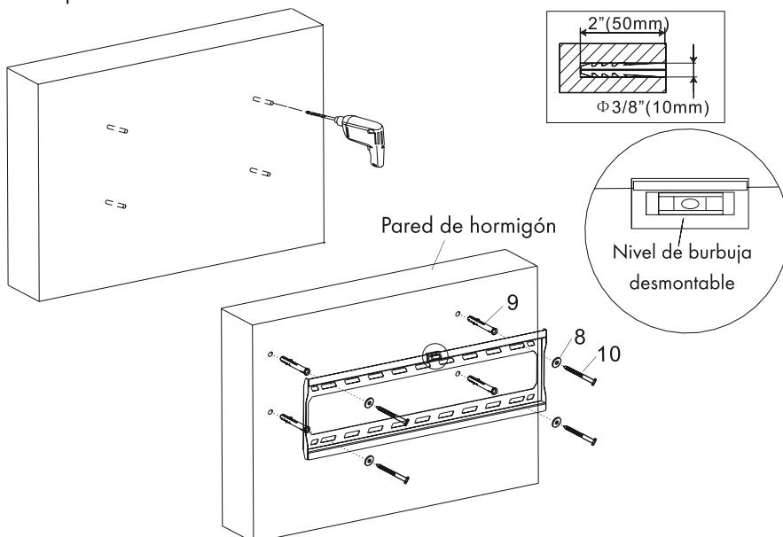
3. Cuando los agujeros están marcados, utilice una broca de 10mm de diámetro (especial hormigón) para perforar los agujeros en una longitud de 50 mm.
