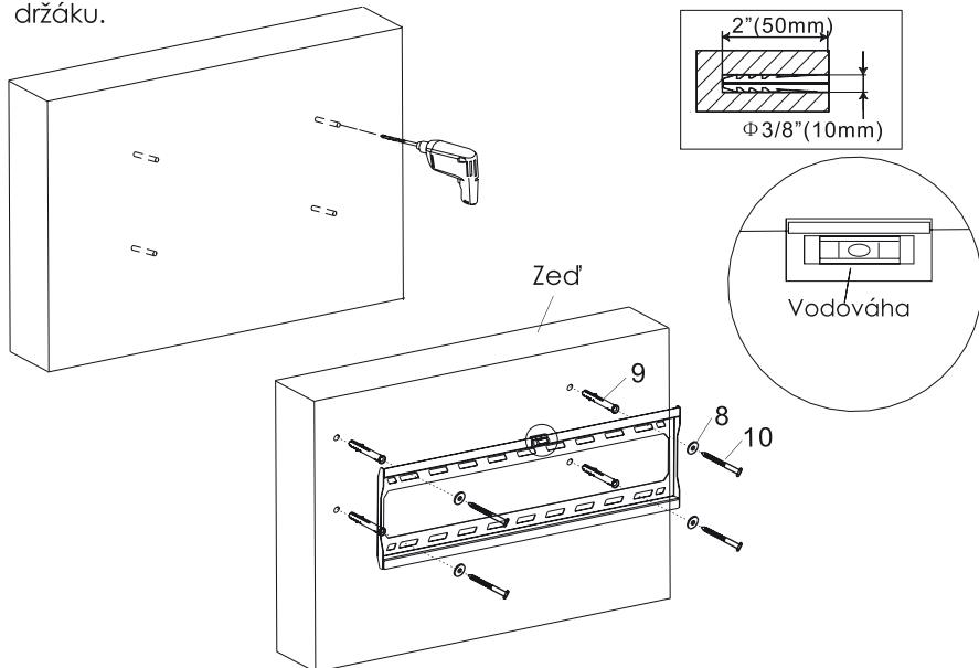
3. Po kontrole otvorů použijte vrták (speciálně do betonu) o průměru 10 mm k vyvrtání otvorů o hloubce min 50 mm.
