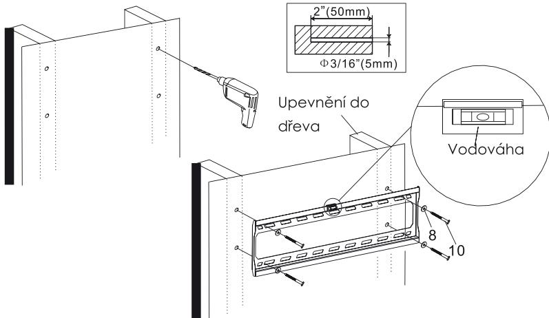
3. Umístěte držák tak, aby díry v něm odpovídaly vyvrstaným díram.
