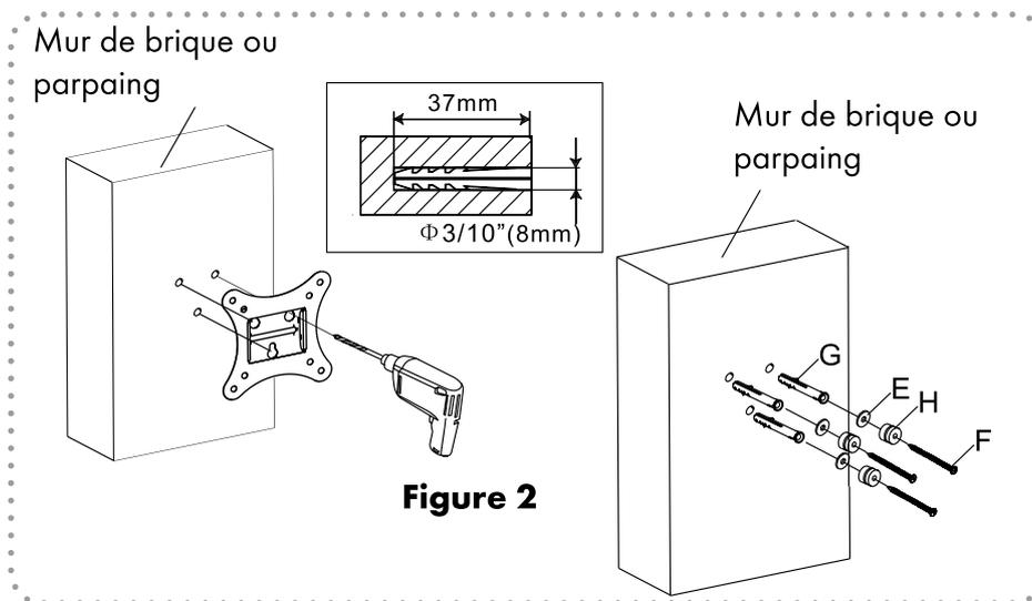
**IMPORTANT** : N'utilisez les chevilles plastiques que pour la fixation dans un mur de béton ou de briques. A ne surtout pas utiliser pour le bois ou pour les plaques de plâtre.
