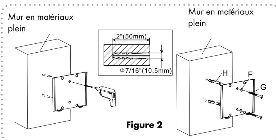
**IMPORTANT** : N'utilisez les chevilles plastiques que pour la fixation dans un mur de béton ou de briques. A ne surtout pas utiliser pour le bois ou pour les plaques de plâtre.
